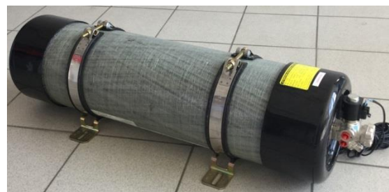
Réservoir de CNG [15]
