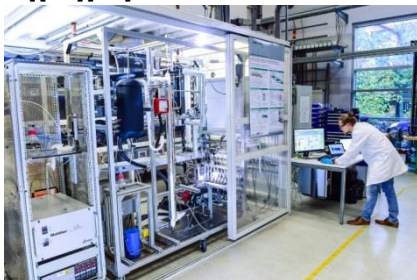
Installation pilote de recherche sur le méthanol synthétique au Fraunhofer ISE (Audi e-benzin) [10]
