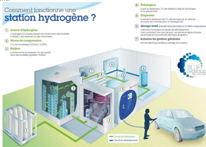
Schéma de principe d'une station hydrogène [5][6]
