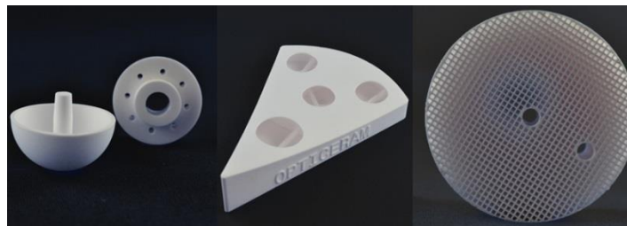
Exemples de pièces réalisées par AM en matériaux céramiques [19]
