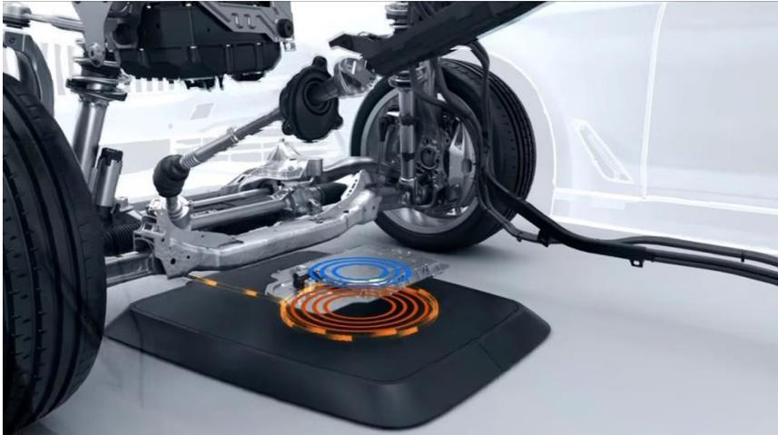
La charge par induction permet de recharger la batterie d'un véhicule hybride sans aucun contact. La plaque, intégrant une bobine, connectée à l'installation électrique et posée au sol permet, en générant un champ magnétique, d'alimenter le convertisseur AC/DC embarqué dans le véhicule, par l'intermédiaire d'une seconde bobine installée sous le véhicule.
